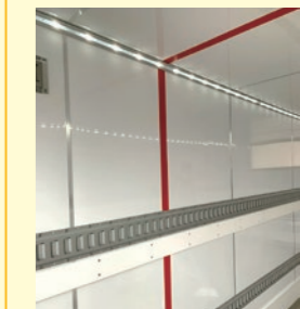
転落防止ライン
